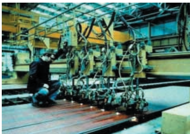
Figure 7 – Machine à oxycouper multitouche à commande numérique
