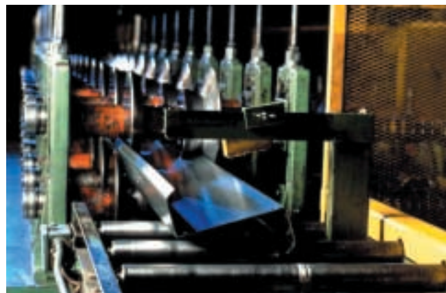
Figure 2 – Fabrication d'une panne Z par profilage à froid
