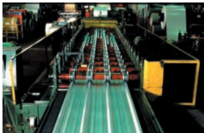
Figure 1 – Profileuse à galets pour tôle de bardage
