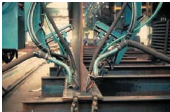
Figure 10 – Soudage semi-automatique sous flux solide
